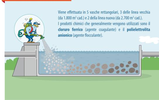
Viene effettuata in 5 vasche rettangolari, 3 delle linee vecchia (da 1.800 m<sup>3</sup> cad.) e 2 della linea nuova (da 2.700 m<sup>3</sup> cad.). I prodotti chimici che generalmente vengono utilizzati sono il **cloruro ferrico** (agente coagulante) e il **polielettrolita anionico** (agente flocculante).
