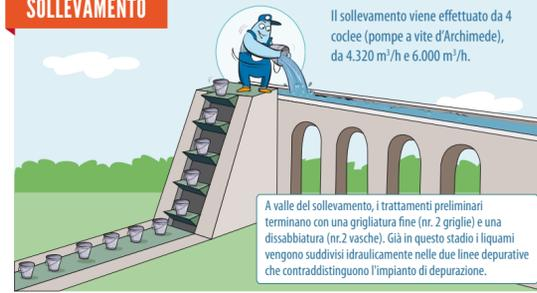
Il sollevamento viene effettuato da 4 coclee (pompe a vite d'Archimede), da 4.320 m<sup>3</sup>/h e 6.000 m<sup>3</sup>/h.
