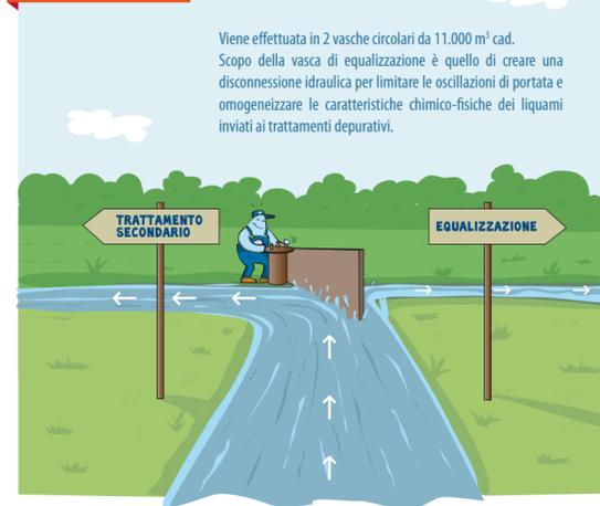
Viene effettuata in 2 vasche circolari da 11.000 m<sup>3</sup> cad. Scopo della vasca di equalizzazione è quello di creare una disconnessione idraulica per limitare le oscillazioni di portata e omogeneizzare le caratteristiche chimico-fisiche dei liquami inviati ai trattamenti depurativi.
